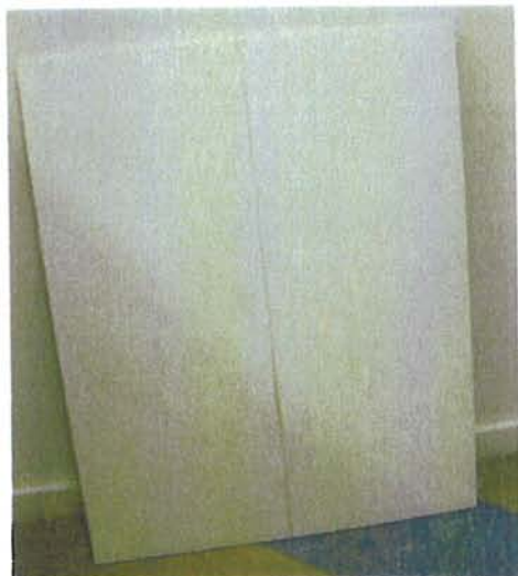
Foto. 1: Prøvestykker med fuging i not/fjær
