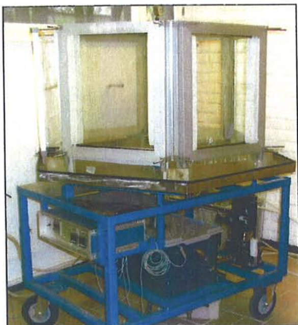
Foto 4 Prøverigg til prøving etter NT BUILD 448
